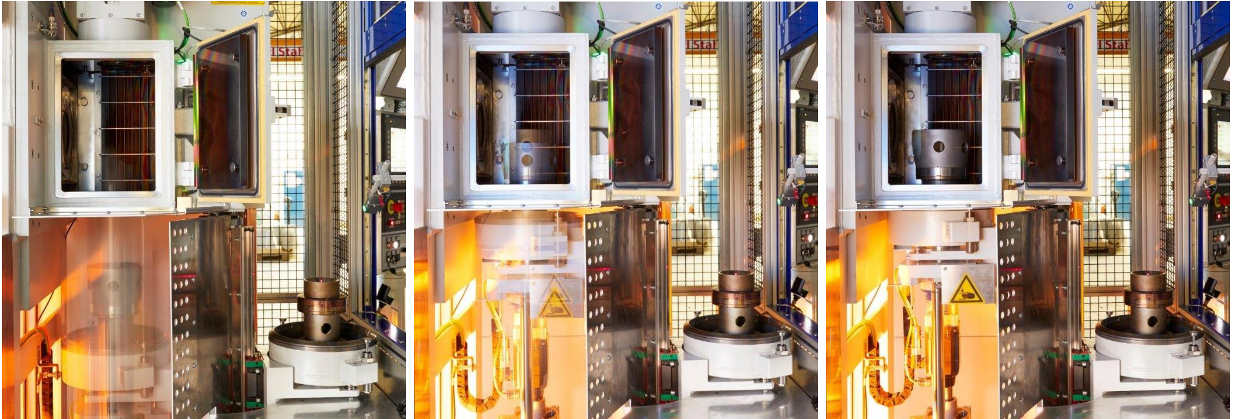
подъем нижней (донной) части камеры
