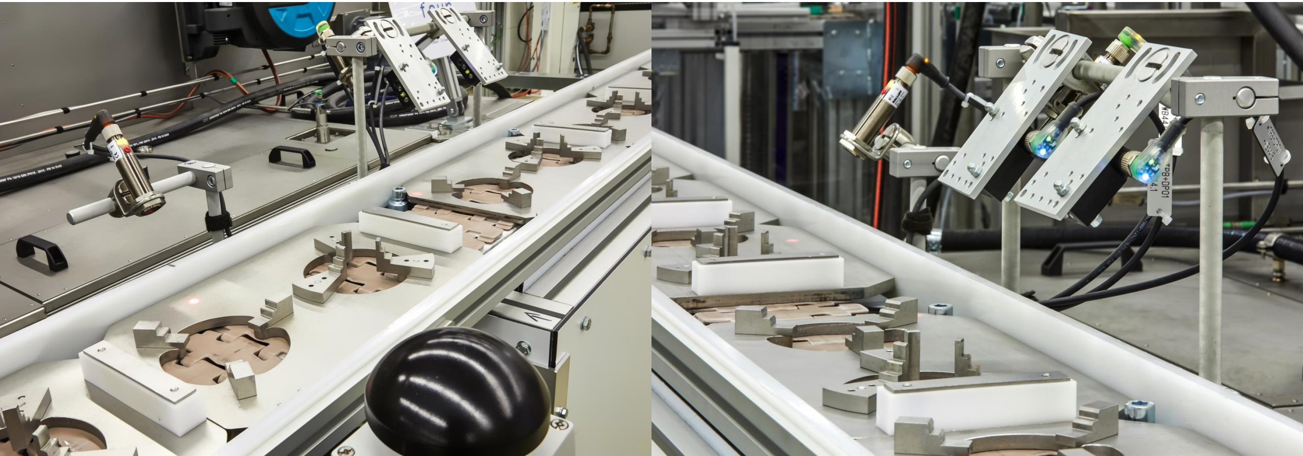
Площадка ручной подачи зубчатых колес на поворотный конвейер
