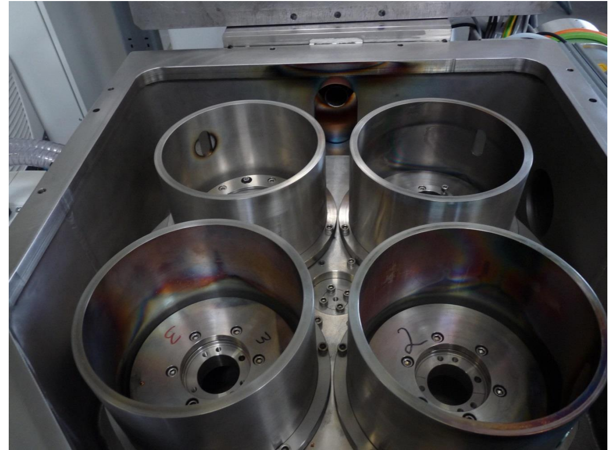
4-элементный поворотный стол (вертикальное положение ЭЛ-генератора (ЭЛГ))
