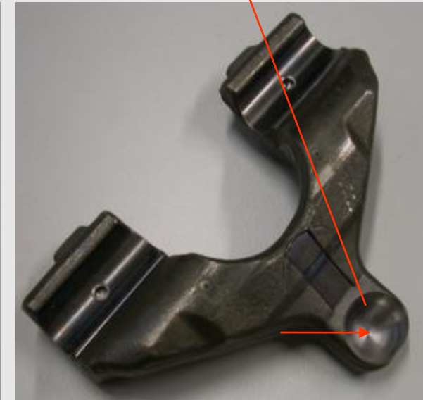
Rht 0,6 + 0,4 мм C45 улучшенный закалкой
