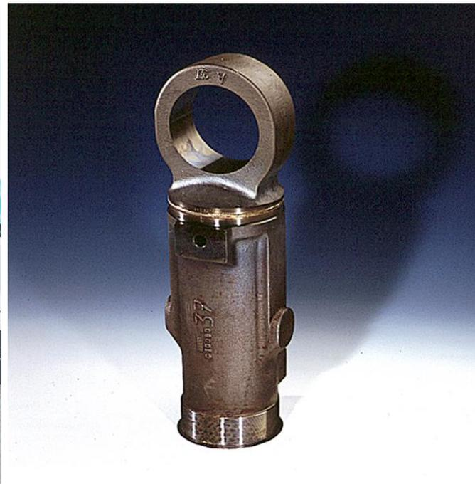
Сварка Сцепки ICE-поездов (скоростных) из высоколигированных сплавов
