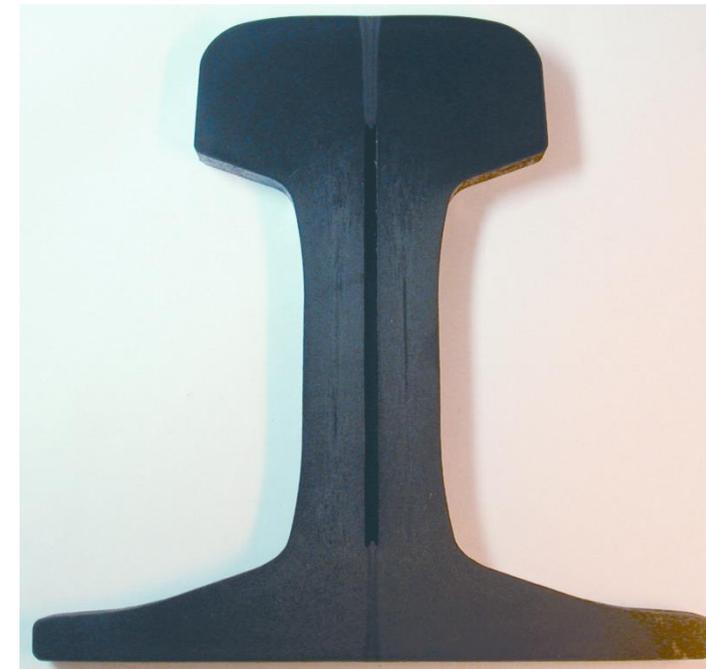
Острые сердечника крестовины стрелочного перевода, механически обработанные и сваренные из стандартных рельсов, и имеющие вид катаных рельсов.
