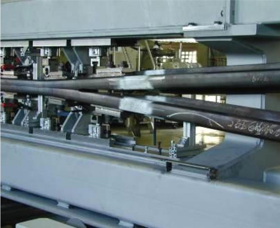
Предварительная сборка рельса в приспособлении
