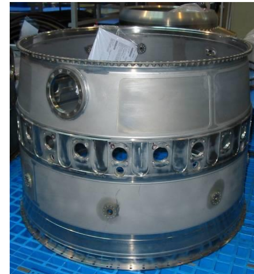
Корпус двигателя Материал: титан
