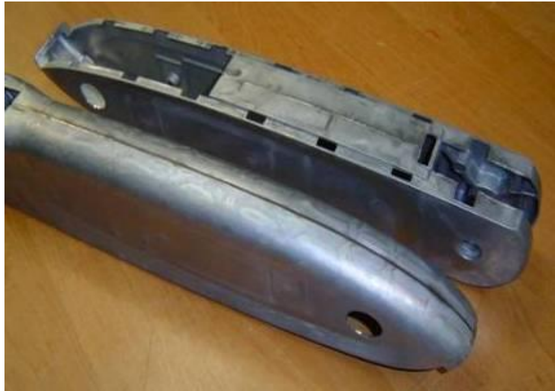
Подлокотник пассажирского сиденья, сваренный ЭЛ (RECARO Aircraft Seating) Материал: алюминиевое литье под давлением
