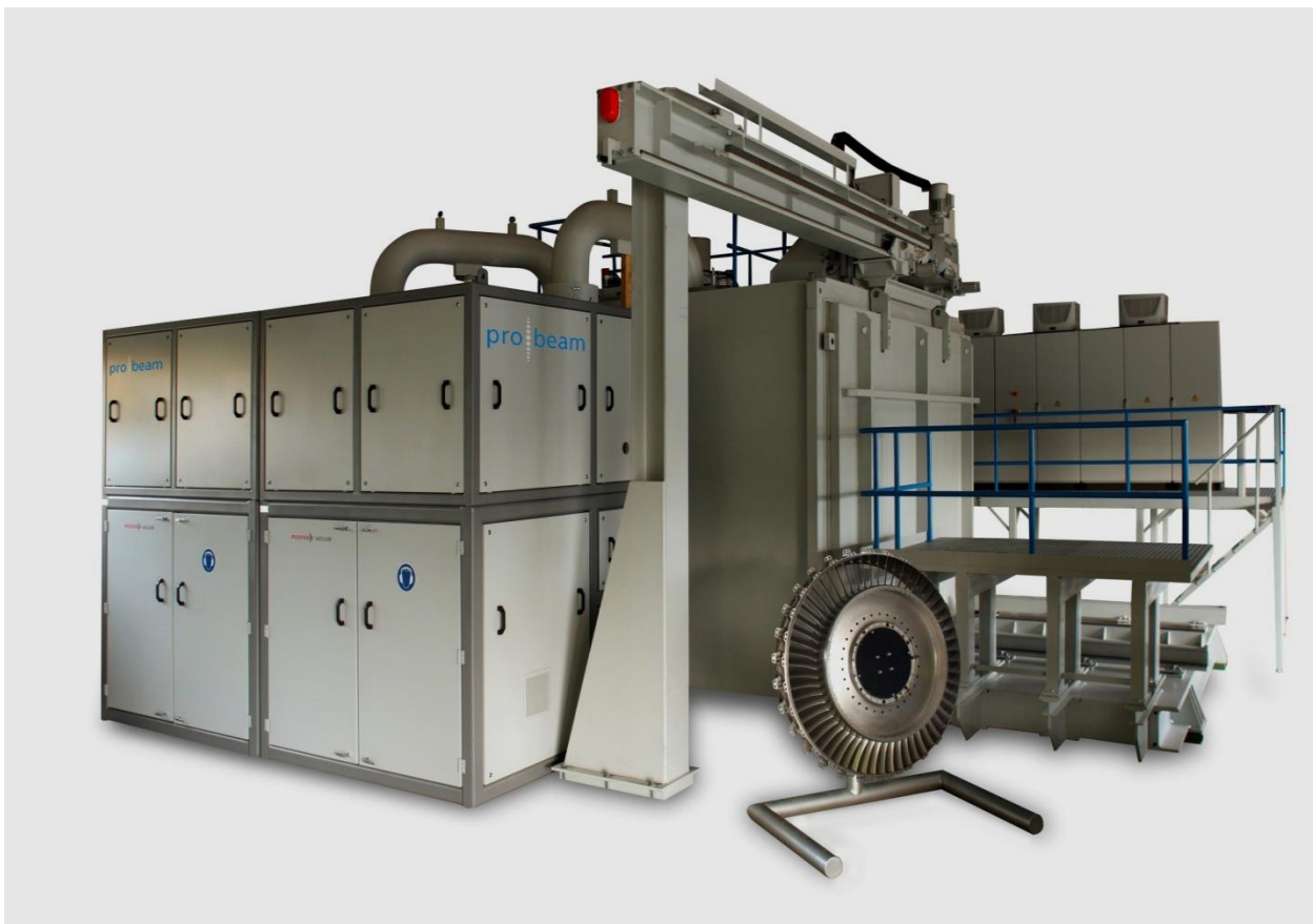
ЭЛ-сварочная машина с камерой 10 м 3 для автоматической сварки сложных турбовентиляторных реактивных двигателей Материал: титан
