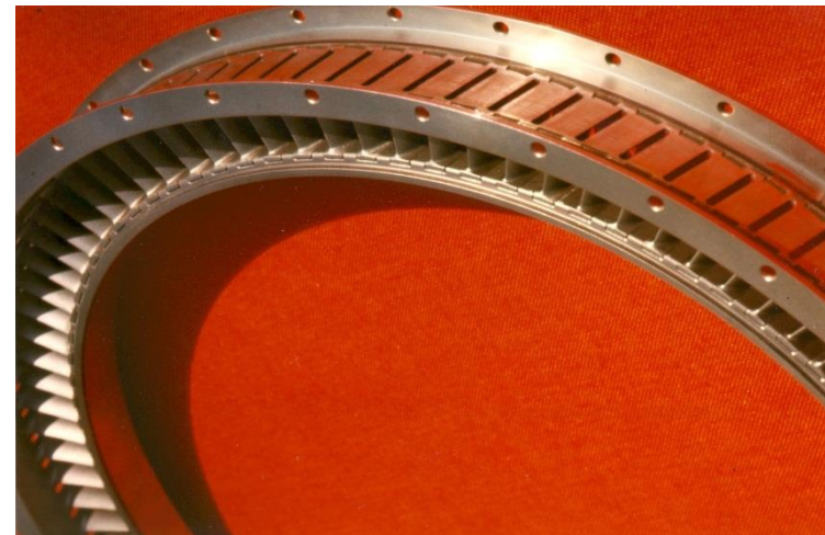
Кольцо статора с более чем 300 Эл-швами для соединения лопастей к кольцу и кольца к фланцам
