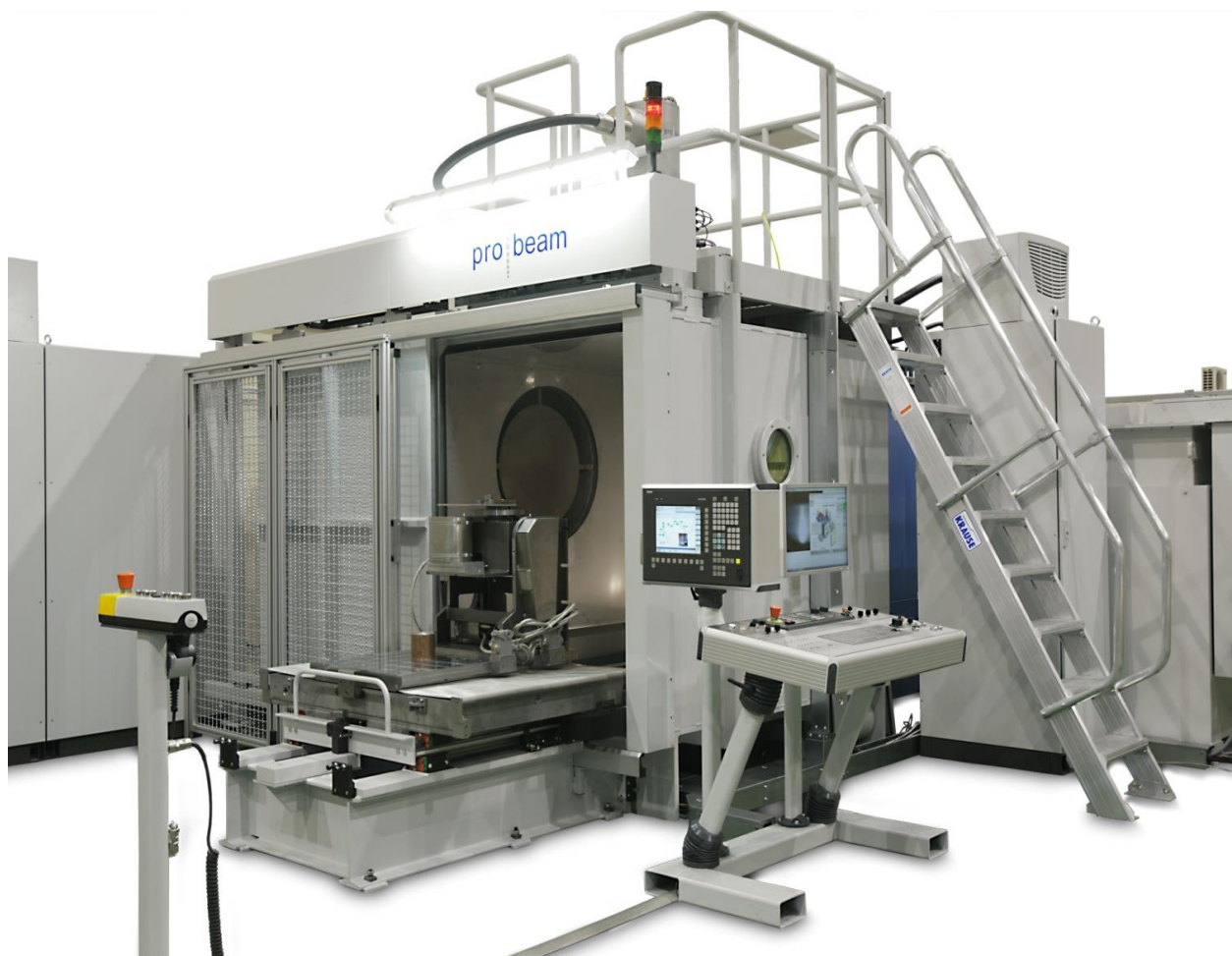
ЭЛ-сварочная машина с камерой 4 м 3 с поворотно-наклонным манипулятором
