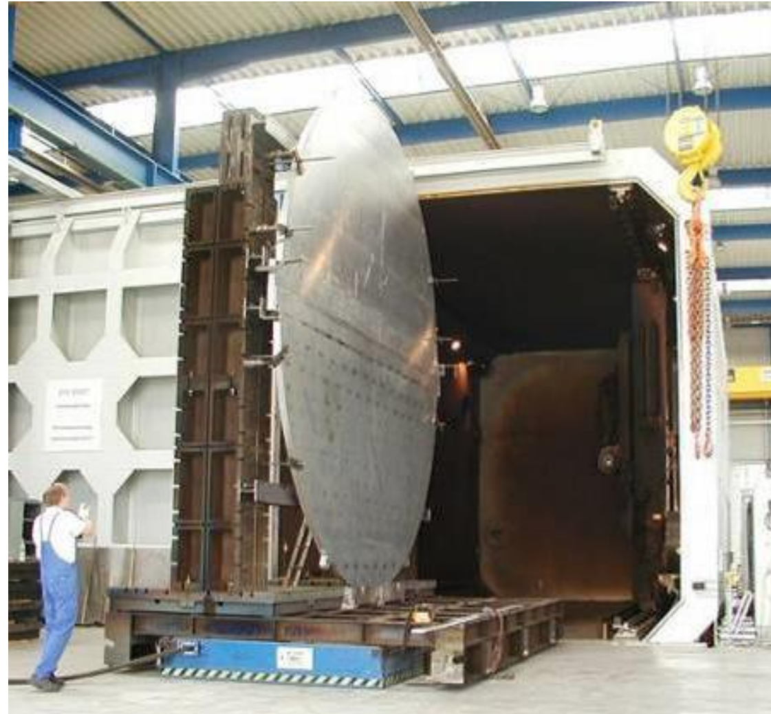
Сварка материалов для больших плит сфер топливного бака АРИАН-5
