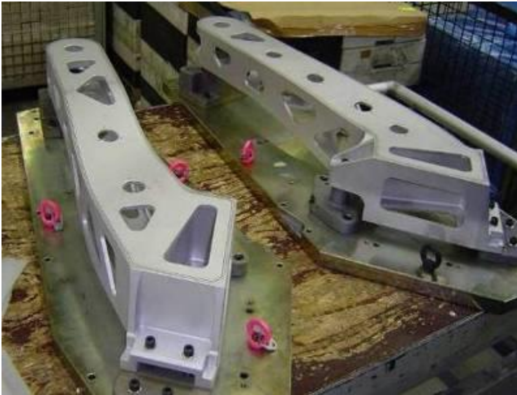
Опорная конструкция, сваренная ЭЛ Материал: алюминий
