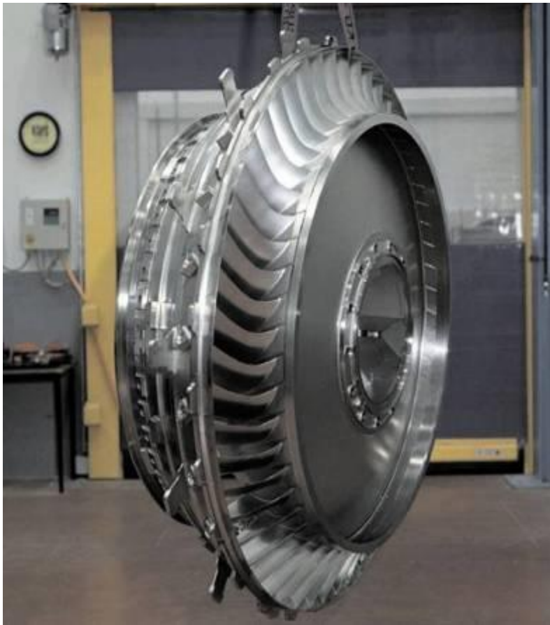
Готовый корпус переднего подшипника с кольцом лопастей
